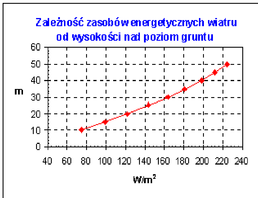
Ryc. 12 Wykres zależności energii wiatru od wysokości n. p. g.. Wielkość uzyskiwanej energii znacznie rośnie ze wzrostem wysokości siłowni wiatrowej, ale i ten parametr ma swoje ograniczenia konstrukcyjne.
